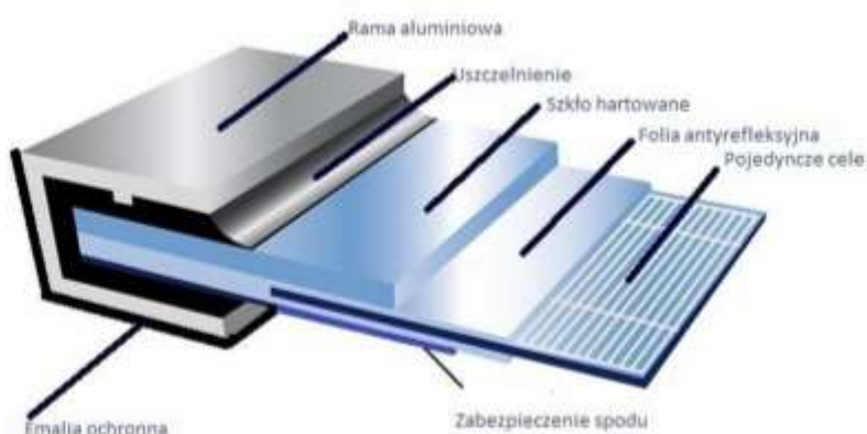
Ryc. 2. Budowa modułu fotowoltaicznego [www.solwat.pl]
